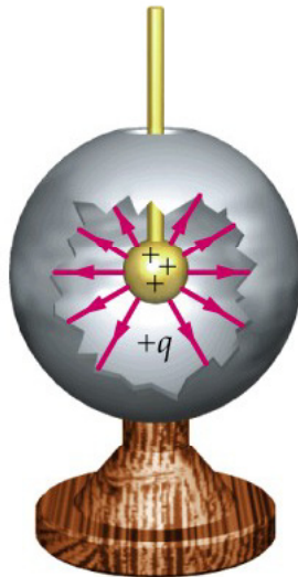
Figura 3.15: Conductor pequeño que posee una carga positiva situado en el interior de un conductor más grande.
