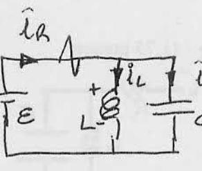
$t=0$   $i_C = \frac{E}{R} e^{-t/RC} = \frac{E}{R} e^0 = \frac{E}{R}$ ;  $i_L = 0$ ;  $i_R = i_C = \frac{E}{R}$
