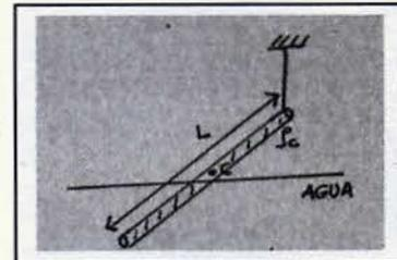
4) Se pretende vaciar un depósito cilíndrico abierto de 4m de altura y 1m de diámetro mediante aspiración del agua por el método del sifón con una goma de sección  $1 \text{ cm}^2$  colocándola según indica la figura, donde  $H$  es el nivel de agua del depósito y  $h_A$  y  $h$  están referidas a la superficie del agua del depósito.
