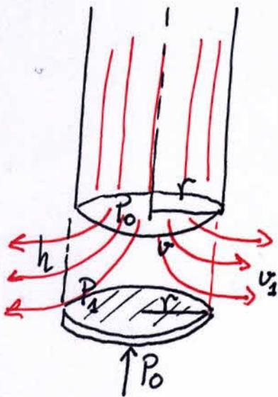
El aire sale del tubo y se esparce por la superficie cilíndrica de radio  $r$  y altura  $h$  cambiando su velocidad y presión
