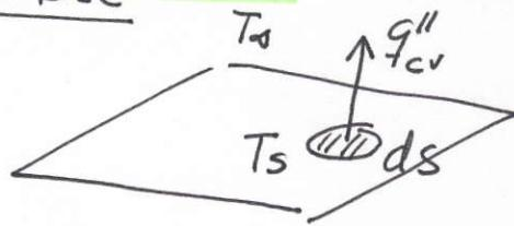
Si  $q''_{cv} = h \cdot (T_s - T_\infty)$  varía segun  $T_s$ , entonces la integral ha de evaluarse una vez se conozca como es la Temperatura de cada elemento de superficie  $T_s$  en  $ds$ .
