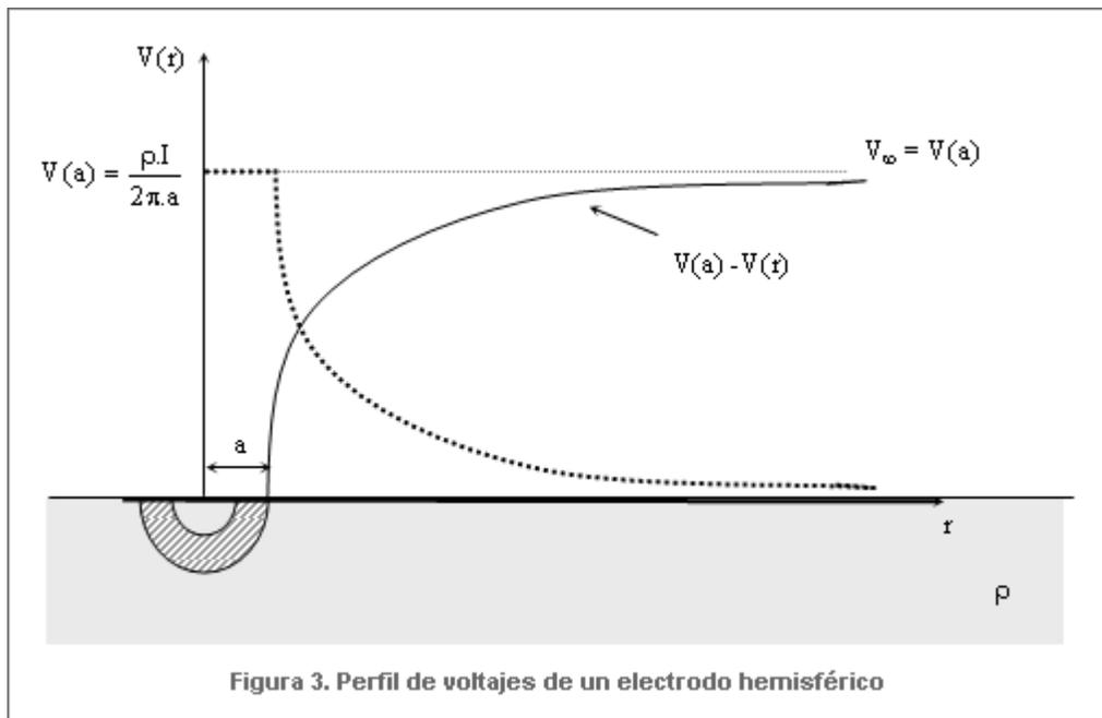
Figura 3. Perfil de voltajes de un electrodo hemisférico
