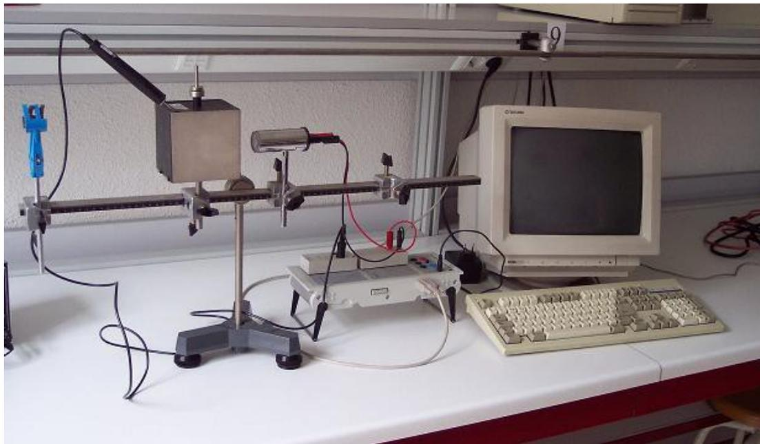
1. Se coloca el cubo de Leslie sobre la plataforma del banco óptico tal y como se indica en la figura adjunta. **Comenzando con la cara negra.**
